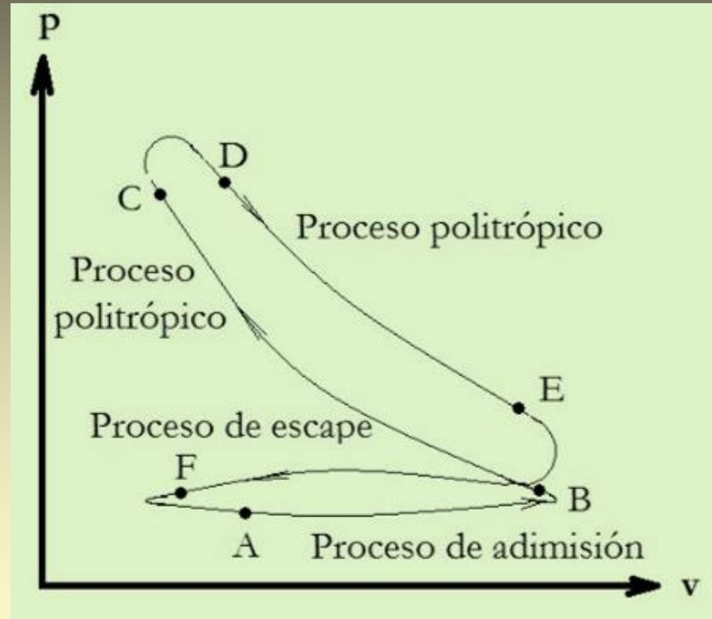
D. Continúa la quema de combustible. La expansión no es adiabática reversible ya que existe intercambio de calor entre los productos de la combustión y las paredes del cilindro.
