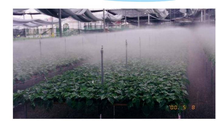
Sistema de irrigación en el cual se expulsa agua en forma de neblina, a través de emisores colocados en la parte superior de los cultivos, el cual además de suministrar agua o fertilizante, contribuye a disminuir temperatura y elevar el nivel de humedad relativa en el interior de los invernaderos.
