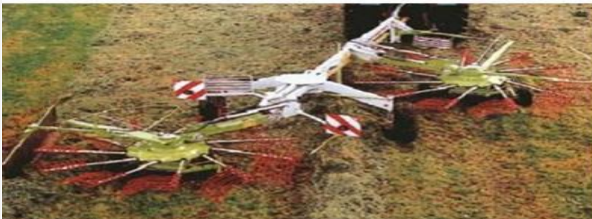
Rastrillo de molinete vertical (hilerador con dos rotores)
