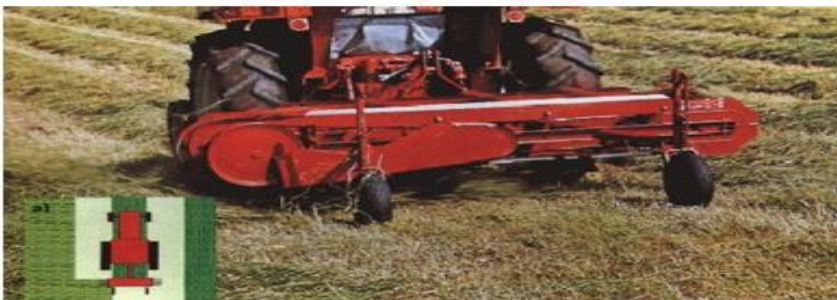
Rastrillo de molinete vertical (volteador-henificador)
