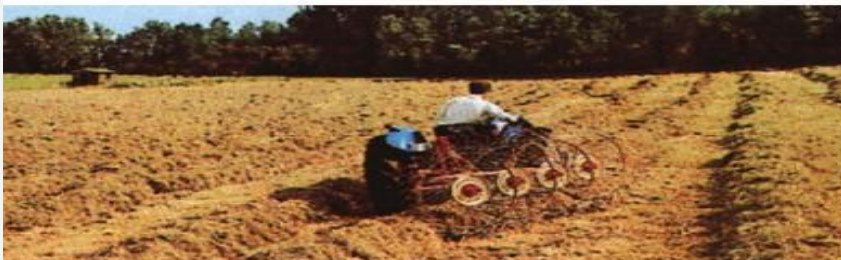
Rastrillo de molinete vertical (hilerador con dos rotores)
