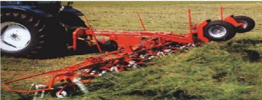
Rastrillo de molinete vertical (volteador-henificador)
