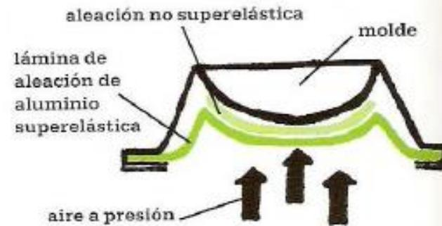
El aire a presión fuerza al aluminio superelástico calentado contra la aleación no superelástica, -también calentada-, que después recubre el molde.
