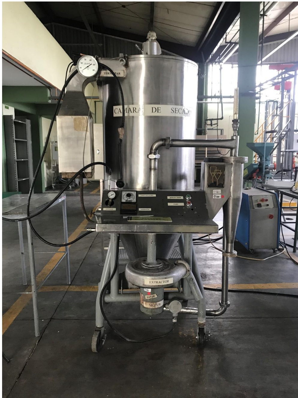
Figura 7. Equipo de Secado por aspersión (Facultad Química, Unidad Cerrillo. UAEMéx).
