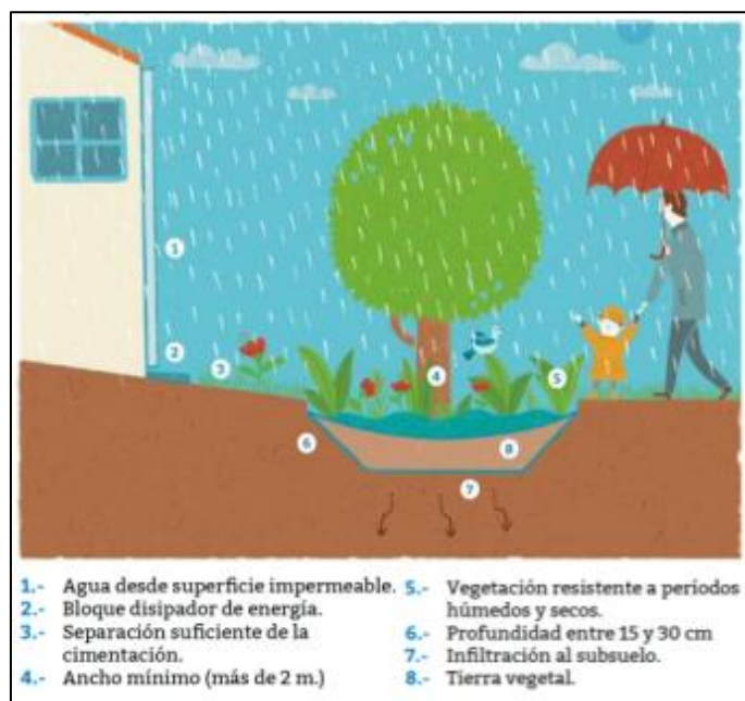
Figura 3.8 Esquema general de un jardín de lluvia (Checa & De Pazos 2018)
