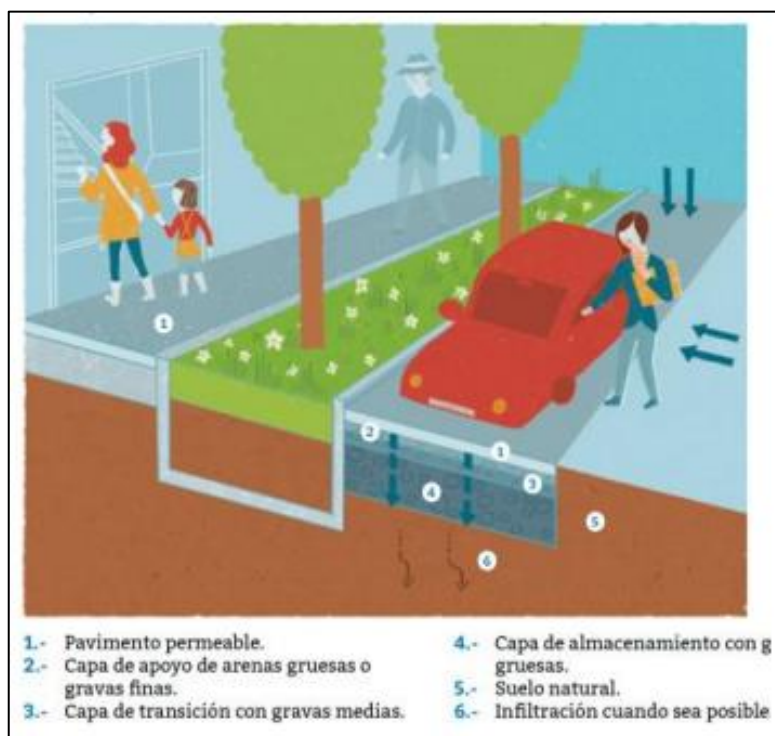
Figura 3.7 Esquema general de un pavimento permeable (Checa & De Pazos 2018)
