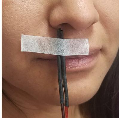
**Figura 2.4:** Ejemplo del uso de un termistor como sensor de respiración.
