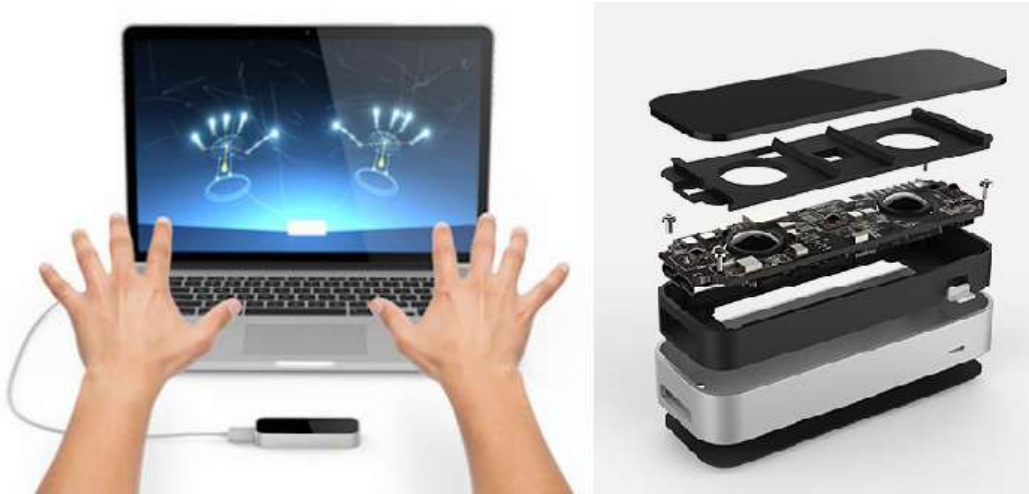
a) Dispositivo óptico de rastreo Leap Motion , b) Componentes del dispositivo
