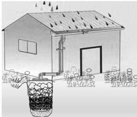
Ilustración 2 Pozo de absorción de agua pluvial
