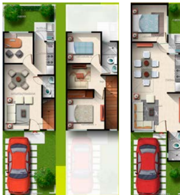
Figura 4. Planta arquitectónica de los Modelos Malva (izquierda) y Modelo Cedrón (derecha). Fuente: Reyes (2015).
