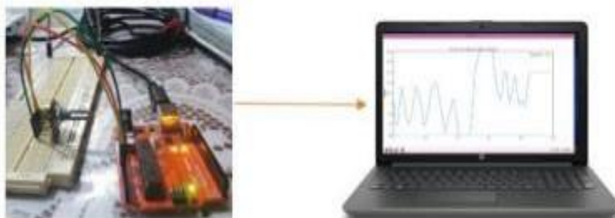
Figura 2. Prototipo 2, adquisición de datos analógicos en Python.
