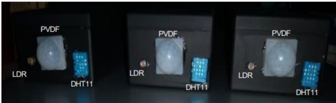
Figura 4.7 Prototipos finales (alojamiento de sensores)
