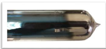
Imagen 10 tubo de boro silicato en óptimas condiciones (página de internet) 2020
