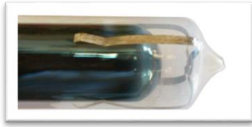
Imagen 11 tubo de vidrio de boro silicato defectuoso, (página de internet)
