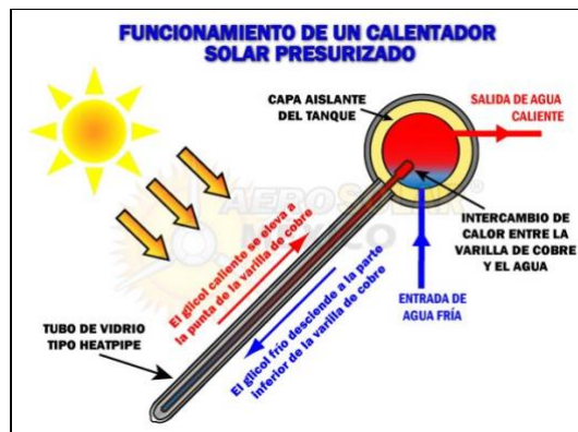
Imagen 12 Funcionamiento de un calentador solar presurizado (página de internet),2020
