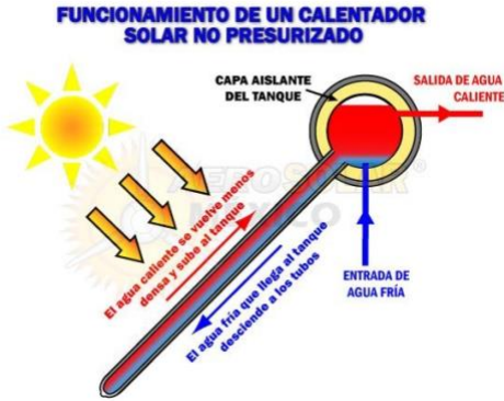
Imagen 8 Como funciona un calentador solar (página de internet),2020
