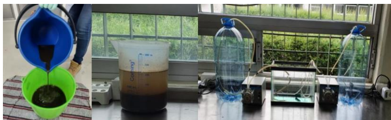
Figura 4.1. Preparación y limpieza del lodo para la Inoculación de LAG en RBS convencional (pecera)
