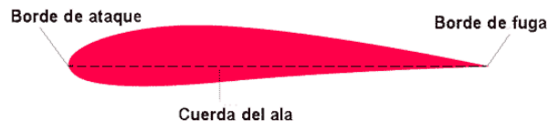
Ilustración 2.2. Forma de un perfil aerodinámico
