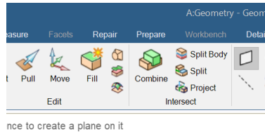
Ilustración 3.23. Herramienta Split Body en SpaceClaim
