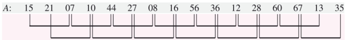
Fig. 6 Tercera pasada de ordenamiento del método de Shell
