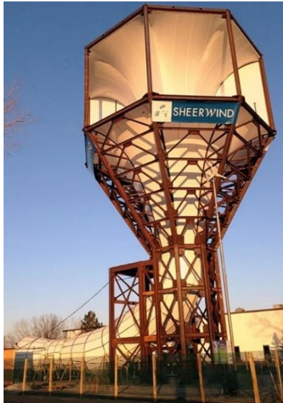
Figura 2.8. Modelo de turbina eólica con sistema concentrador acoplado, The Sheerwind Invelox Wind Turbine®. Obtenida de Eric, (2013).
