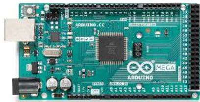
Figura 15: La tarjeta de desarrollo Arduino Mega 2560, un componente esencial del sistema que proporciona una plataforma versátil y potente para la conexión y el control digital y analógico.
