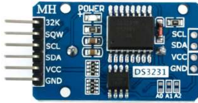
Figura 18: El módulo RTC, componente esencial en el sistema para garantizar un seguimiento preciso del tiempo durante los experimentos.
