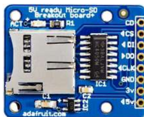
Figura 17: La Adafruit MicroSD Card Breakout Board, que permite al sistema almacenar y recuperar datos de los experimentos.
