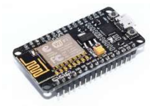
Figura 16: La tarjeta de desarrollo NodeMCU, que añade capacidades de conexión Wi-Fi al sistema.
