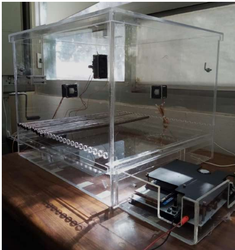
Figura 36: Sistema de condicionamiento.
