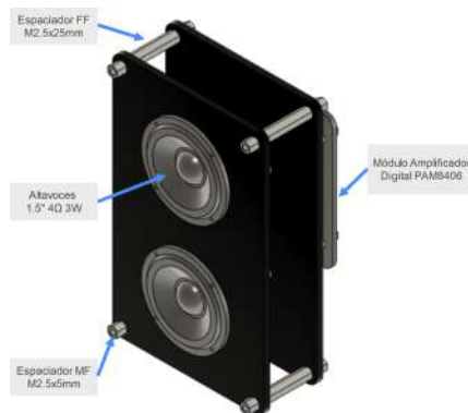
Figura 32: Representación visual del Módulo de Audio, incluye el amplificador PAM8406 y dos altavoces externos utilizados para la generación y amplificación del tono de estimulación.
