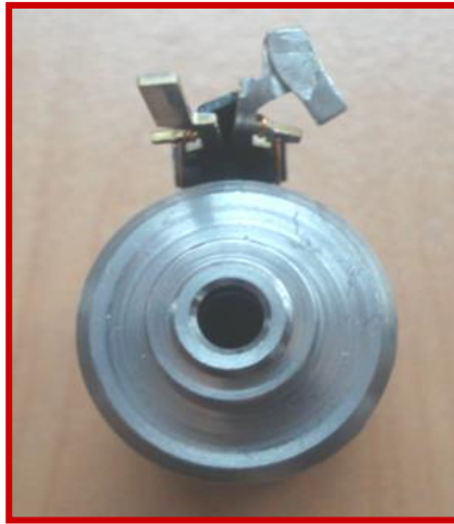
Figura IV.43. Ejemplo de falla Terminales dobladas en el grupo magnético 326.
