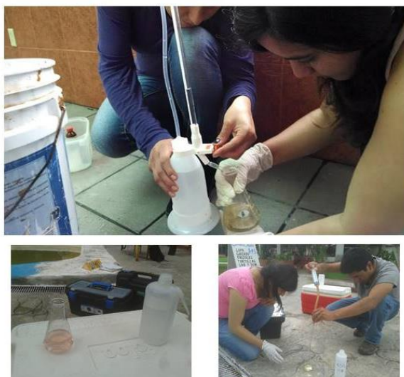
Figura 4.13. Determinación de alcalinidad en campo
