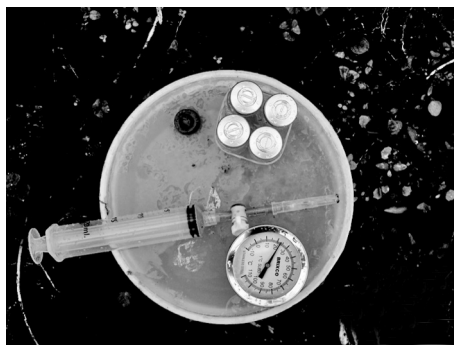
B) Instrumentos para el muestreo: recipientes liofilizados, termómetro y jeringa extractora.
