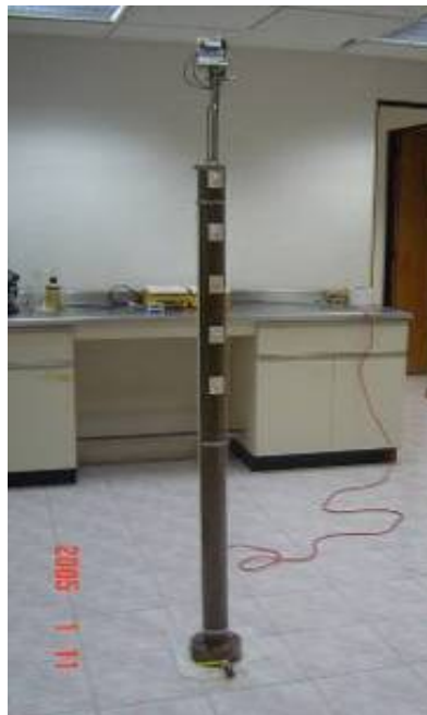
Figura 5.5.- Columna de sedimentación
