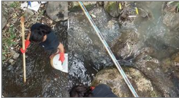
Figura 10. Medición de profundidad con barra de madera graduada (1 metro)
