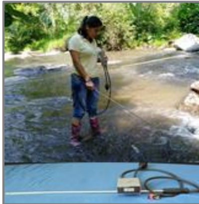
Figura 11. Toma de temperatura del agua ( T °C) y el oxígeno disuelto utilizando monitor de Oxígeno-Temperatura modelo OT-21 DEMISTA INSTRUMENTS
