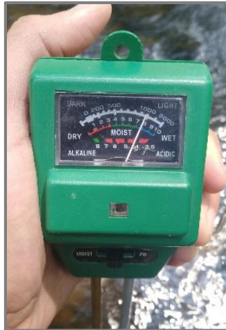
Figura 13. Tester Medidor de pH y Luz. Para medir la intensidad de luz
