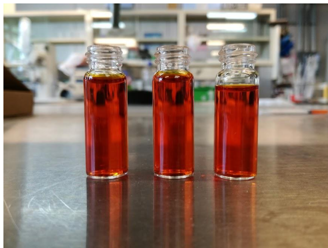
Figura 21. Viales con mezcla de OPD y cloruro de hierro en metanol a evaporación a temperatura ambiente.
