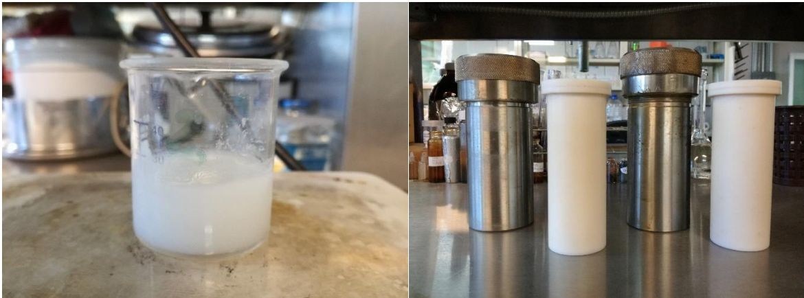
Figura 19. De izquierda a derecha respectivamente, vaso de precipitado conteniendo todos los reactivos mezclándose. Imagen izquierda, autoclave de acero inoxidable junto con su respectiva línea de teflón.
