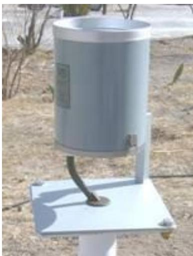
**Figura 1.12 Pluviómetro**
