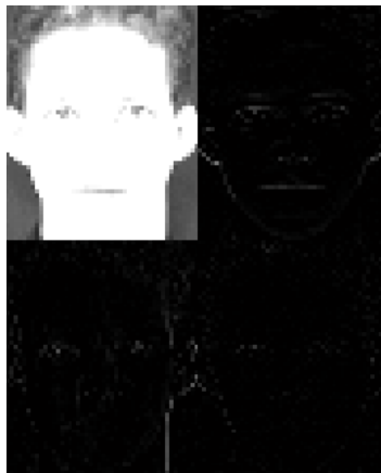
Figura 2.10. Ejemplo de descomposición de una imagen empleando Wavelets de Daubechies.
