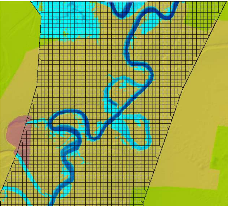
Figura 3-19 Ejemplo de malla 2D demasiado pequeña respecto a la planicie de inundación esperada
