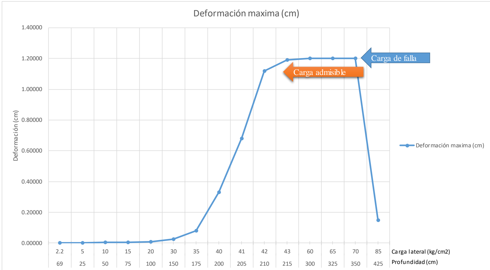
Figura 27. Deformaciones para la pieza autoportante con sección de 0.6 mm.
