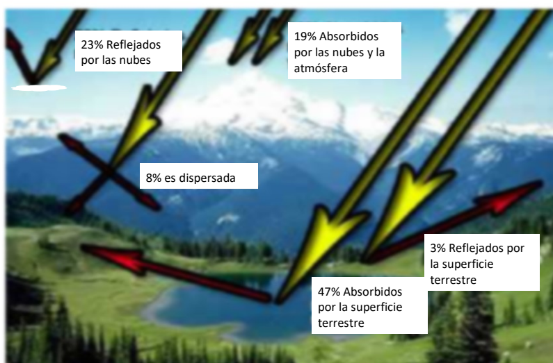
Figura 5. Balance de la radiación solar en interacción con la atmósfera. Fuente: Vivancos et al.,2005.
