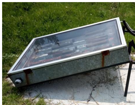
Figura 8 Colector solar empleado en los tratamientos por fotólisis y Fenton heterogéneo solar.
