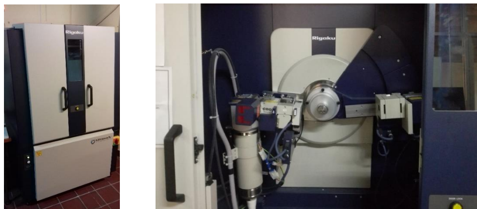
Figura 2.10. Equipo de PXRD marca Rigaku® (izq) y la cámara interior del difractómetro (der).
