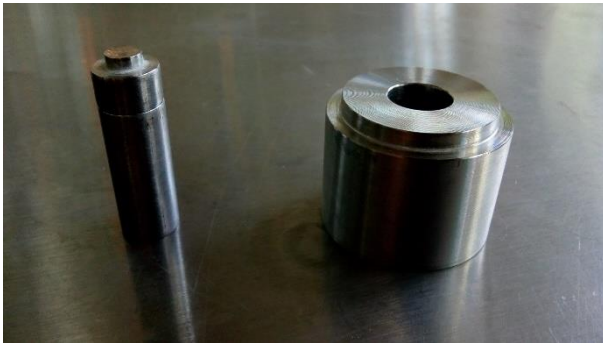
Figura 2.1. Molde de acero inoxidable para soportes tubulares.
