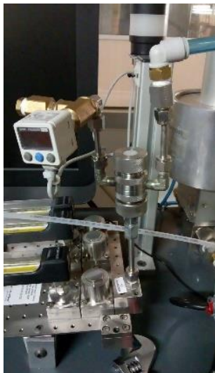
Figura 3.17. Módulo de separación de gases en el equipo de permeación.
