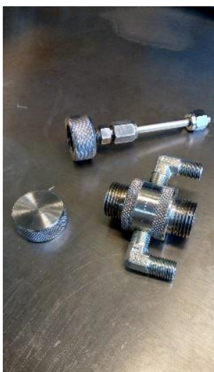
Figura 3.15. Piezas del módulo de separación en acero inoxidable.
