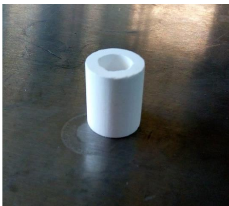
Figura 2.5. Soporte tubular de \alpha - Al_2O_3 pulido.
