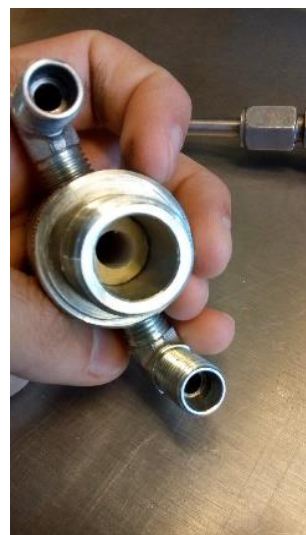
Figura 3.16. Vista interior del módulo de separación de gases.
