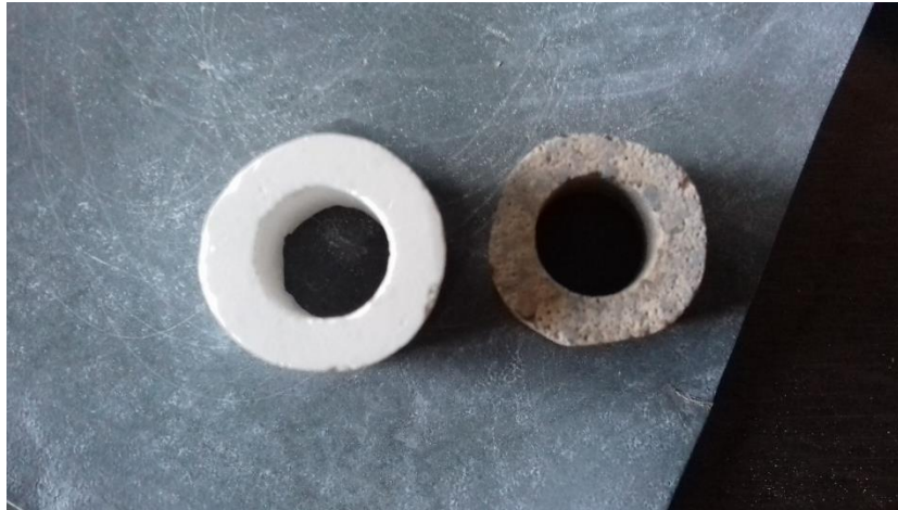
Figura 2.8. Soportes tubulares antes (izq.) y después (der.) de la modificación de su superficie.
