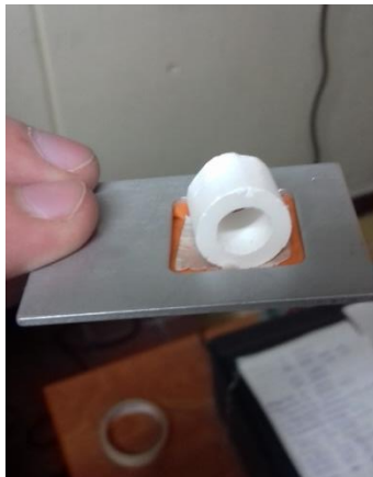
Figura 2.11. Soporte tubular sobre Holder para XRD.
