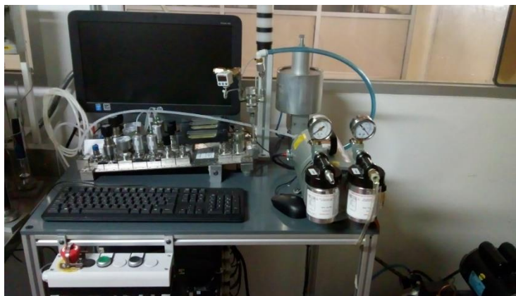
Figura 2.13. Equipo de permeación de gases.
