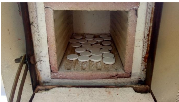
Figura 2.3. Soportes en disco de \alpha - \text{Al}_2\text{O}_3 al finalizar el tratamiento térmico.
