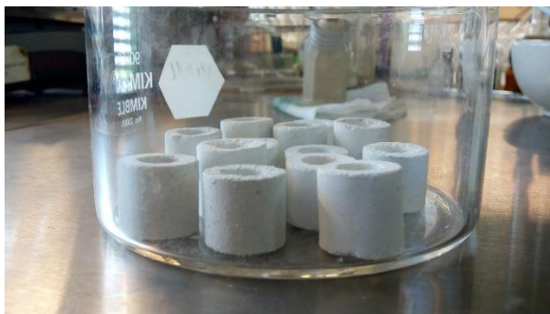
Figura 2.4. Vaso de precipitados con soportes tubulares de \alpha - Al_2O_3 listos para el crecimiento de cristales.
