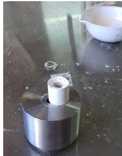
Figura 2.2. Soporte tubular de \alpha - \text{Al}_2\text{O}_3 previo al tratamiento térmico.
