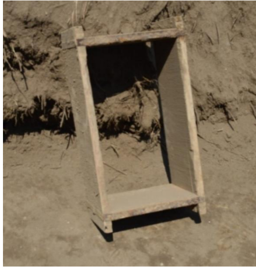
Fotografía 3: Molde para adobes
