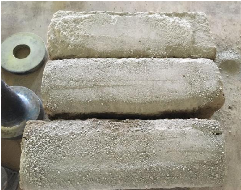
Fotografía 65: Cubierta de arena sobre los adobes
