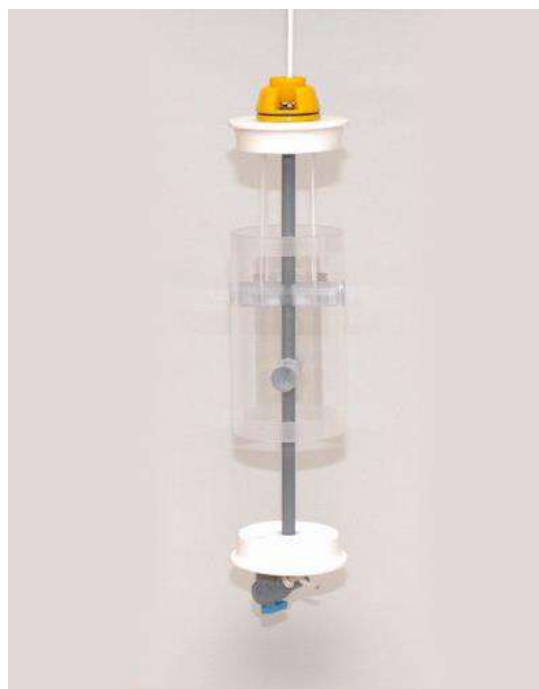
Figura 6.11 Muestreador Kemmerer con cierre superior e inferior abierto (foto Royal Eijkelpamp).
