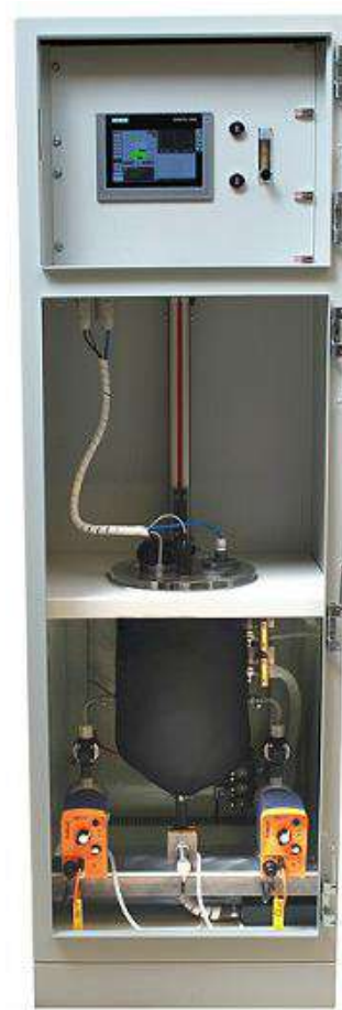
Figura 3.21 Ejemplo de versión comercial de respirómetro basado en el principio LFE y usando el arreglo mostrado en la Figura 3.20. En el centro aparece el recipiente termostatzado y en el fondo, a la izquierda y la derecha, bombas para agua residual y soluciones para calibrar, respectivamente (foto: Kelma NV).
