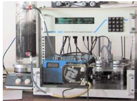
Figura 3.23 Versión comercial de un respirómetro del principio LEF usando el arreglo mostrado en la Figura 3.22. A la izquierda está el tanque de aireación. En la caja a la izquierda está la bomba de muestreo, y a la derecha, las válvulas solenoides. La celda respirométrica está colocada detrás de las válvulas (foto: Applitek NV).
