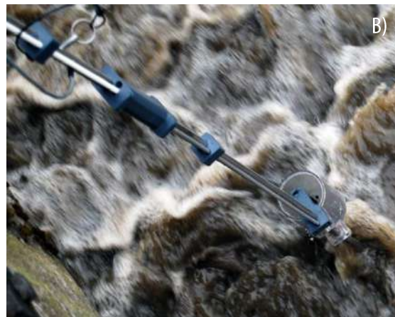
Figura 3.18 Ejemplo de implementación de respirometría siguiendo el principio de medición LEE. (A), electrodo de OD y (B), uso in situ del respirómetro, en este ejemplo flotando sobre el lodo activado de un tanque de aireación (fotos: Strathkelvin Instruments Ltd.).
