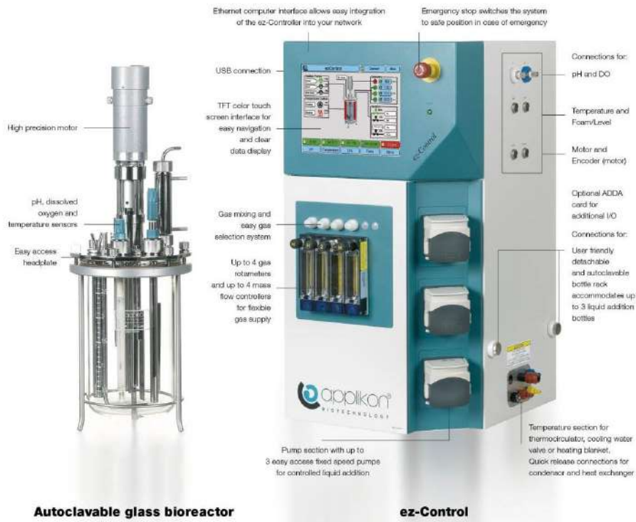
Figura 2.5.3 Bioreactor de alta tecnología para la realización de ensayos batch o continuos de cultivos microbianos (foto: Applikon Biotechnology B.V., 2016).
