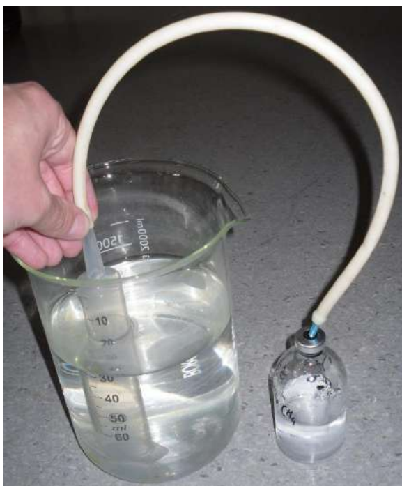
Figura 4.4 Medición del volumen de expansión debido al aumento de presión causado por la salinización del líquido y evacuación de los gases (foto: van Dongen, 2015).
