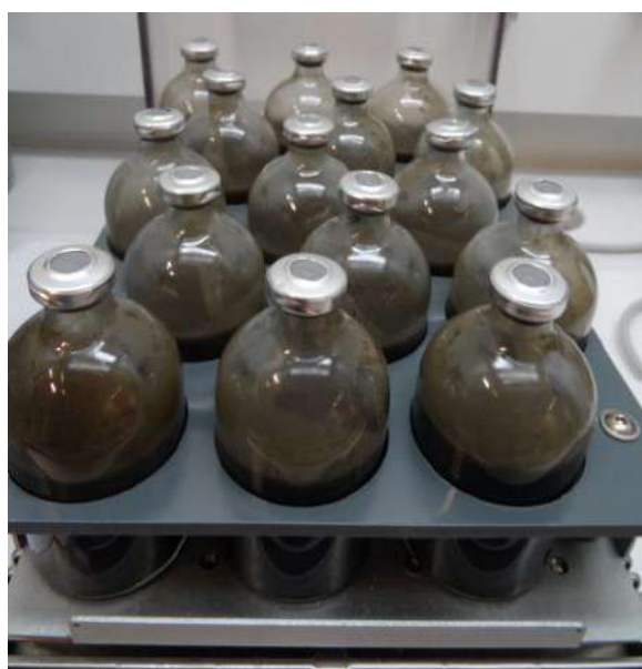
Figura 2.3.7 Botellas de suero con lodo de SRB colocadas en un agitador orbital (Foto: Van den Brand, 2015).
