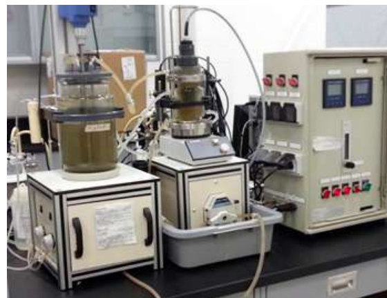
Figura 3.19 Ejemplo de otra implementación práctica siguiendo el principio de medición LEE (foto: P.A. Vanrolleghem).
