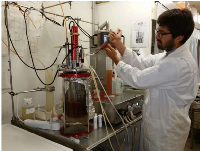
Figura 2.4.15 Ejecución de un ensayo de actividad en batch. Observe el color rojizo típico del cultivo anammox enriquecido (foto: Lotti, 2015).
