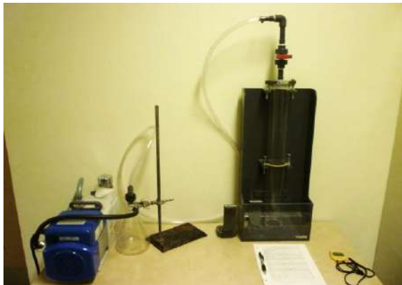
Figura 6.23 Aparato ViCAs con equipo de llenado (foto: Gromaire M.C. y Chebbo G, manual ViCAs).
