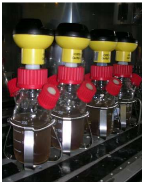
Figura 2.4.2 Aparato comercialmente disponible para realizar ensayos manométricos para propósitos de desnitrificación (foto: Lotti, 2016).
