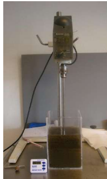
Figura 6.12 Configuración experimental para la prueba SSF. Una muestra de lodo activado es agitada durante 30 min en una jarra de floculación cuadrada (foto: E. Torfs).
