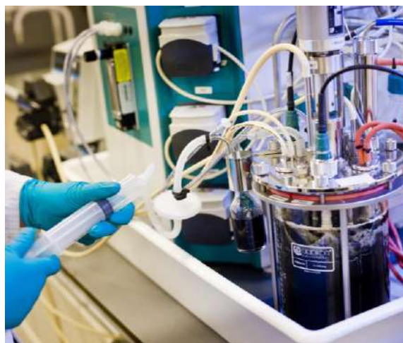
Figura 2.3.11 Toma de una muestra líquida para determinar la actividad de las bacterias sulfato reductoras (SRB). Nótese el color oscuro característico de la biomasa de SRB en el reactor. (Foto: KWR Watercycle Research Institute, 2014).
