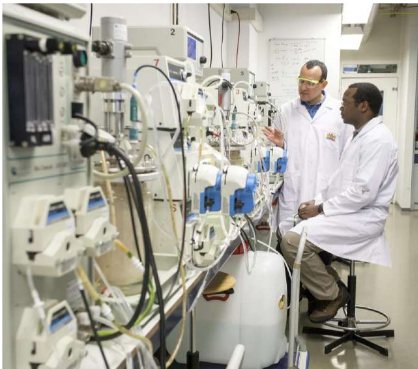
Figura 2.1.1 Instalaciones experimentales para ensayos de actividad de lodos activados en el Instituto IHE Delft en Educación del Agua ( www.un-ihe.org ) en Holanda (foto: IHE Delft Institute for Water Education).
