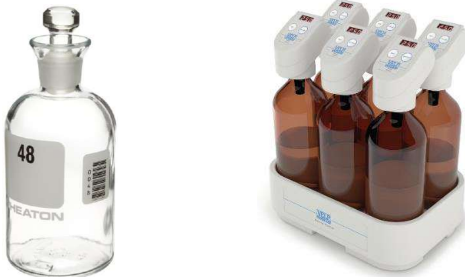
Figura 3.16 Botella de DBO para el análisis clásico de la DBO (a la izquierda) y frascos manométricos para la medición continua del consumo de oxígeno (a la derecha) (fotos: de Wheaton y de VELP Scientifica).
