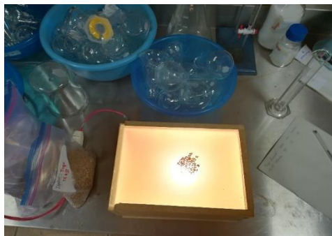
Figura No. 10. Determinación de harinosidad de la malta.
