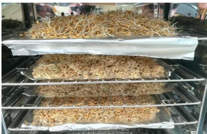
Figura No. 9. Secado en estufa con circulación de aire caliente.
