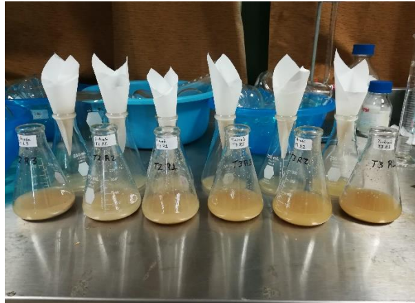
Figura No. 11. Determinación del extracto de las maltas.
