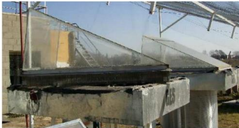
Figura 1. Destilador solar de una vertiente. (Marchesi, Ducculi, Adaro, & Fasulo, 2006)
