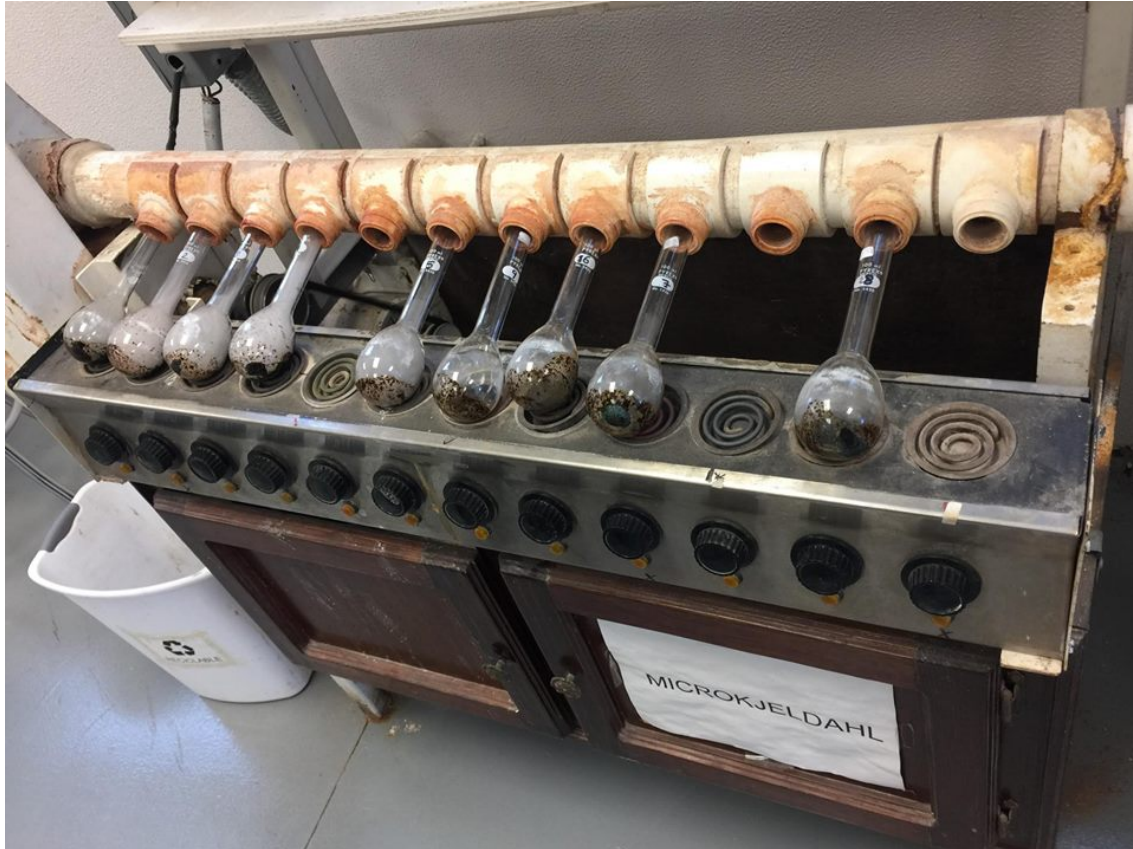
Figura 8. Equipo Microkjeldahl para determinación de proteína.
