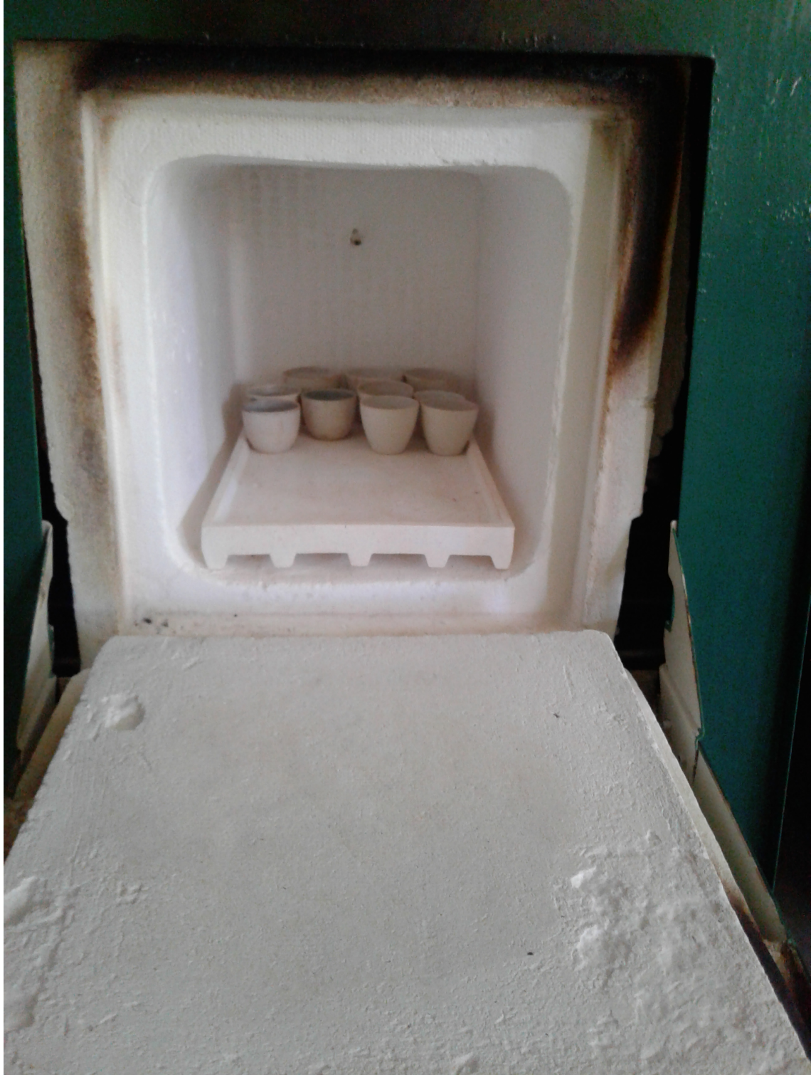
Figura 7. Mufla para determinación de cenizas.
