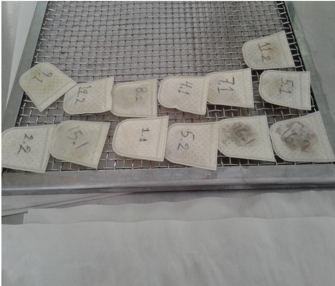
Figura 12. Bolsas para determinación de FDN y FDA.
