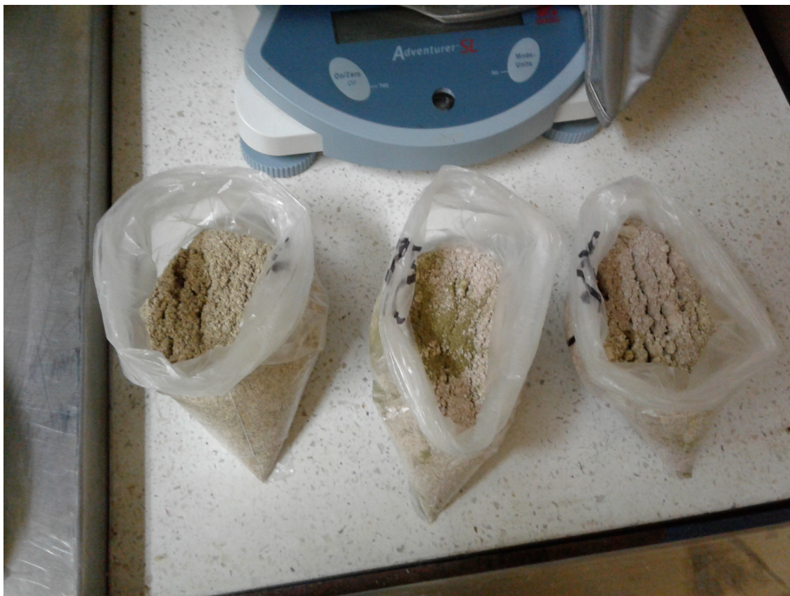
Figura 6. Pesaje de muestras para determinación de cenizas.
