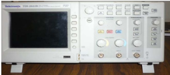
Fig. 5. Osciloscopio de Tektronix® modelo TDS 2022B (elaboración propia).
