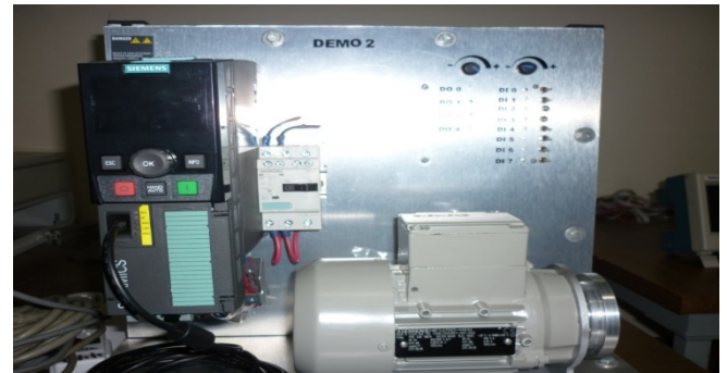
Fig. 2. Sistema inversor de Siemens® y motor trifásico físicamente (elaboración propia).
