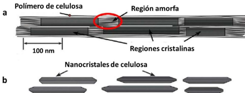
Figura 12. Representación esquemática de las nanofibrillas y nanocrisales de celulosa. a) Estructura hipotética donde se muestra la microfibrila constituida por regiones cristalinas y amorfas, b) nanocrisales de celulosa resultantes tras disolver las regiones amorfas mediante hidrólisis ácida (Moon et al., 2011).
