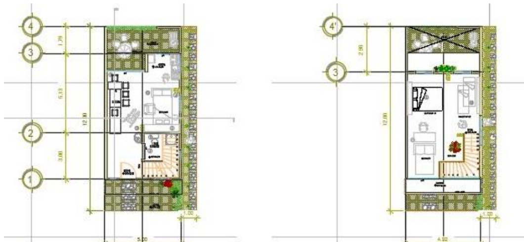
Imagen 3 Planta arquitectónica propuesta, accesible, con escasez de muros divisorios, espacios flexibles, mobiliario transformable, eliminación de espacio para el vehículo e incremento de áreas verdes y permeables (Diseño de Montoya, 2019)
