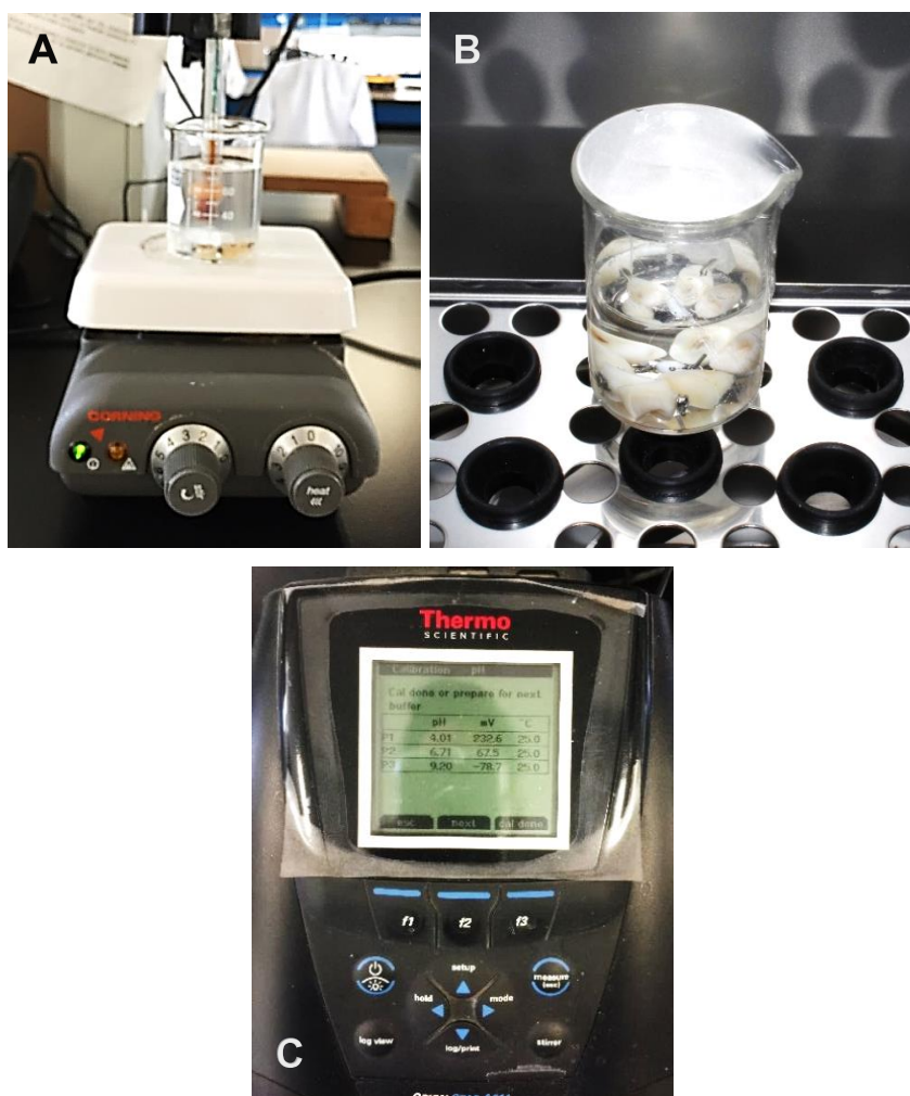
Figura 5. Corrosión de aparatología metálica. A. Medición de pH de la solución corrosiva. B. Muestras en incubadora con agitación. C. Potenciómetro para medir pH.
