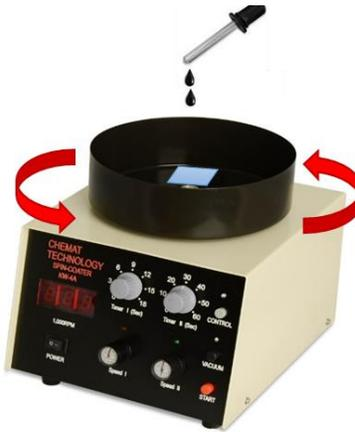
Figura 1.5: Esquema del proceso de depósito por giro.
