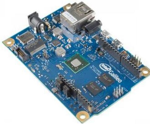
Figura 2.6. Tarjeta Intel Galileo.
