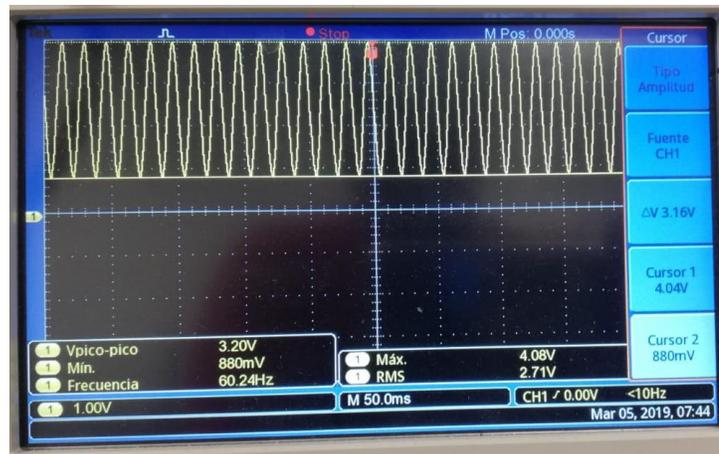
Figura 3.6. Señal de salida del sensor con carga 2300W alimentada con AC.
