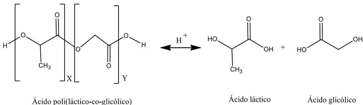
*Figura 2. Estructura del PLGA y la formación de sus productos de degradación.*
