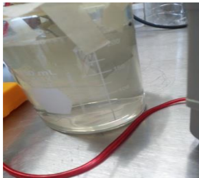
Figura 8. Tratamiento electroquímico con electrodos de Hierro.
