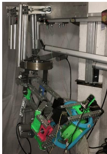
Figura 5-24 Prueba del ERMIS haciendo la rotación interna externa del hombro.
