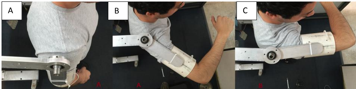
Figura 4-3 Pruebas con la barra L soporte del hombro del ERMIS. A) Estado natural del hombro. B) Movimiento combinado del hombro flexión/abducción y C) Extensión del hombro. Fuente [63]
