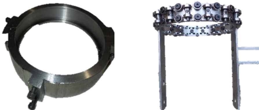
Figura 4-6 Modelo Físico experimental de la articulación anillos deslizantes formada por carro y riel.
