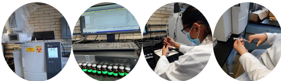
Figura 25. cromatógrafo de gases marca Shimadzu modelo GC-2014 Greenhouse Gas Analyzer.
