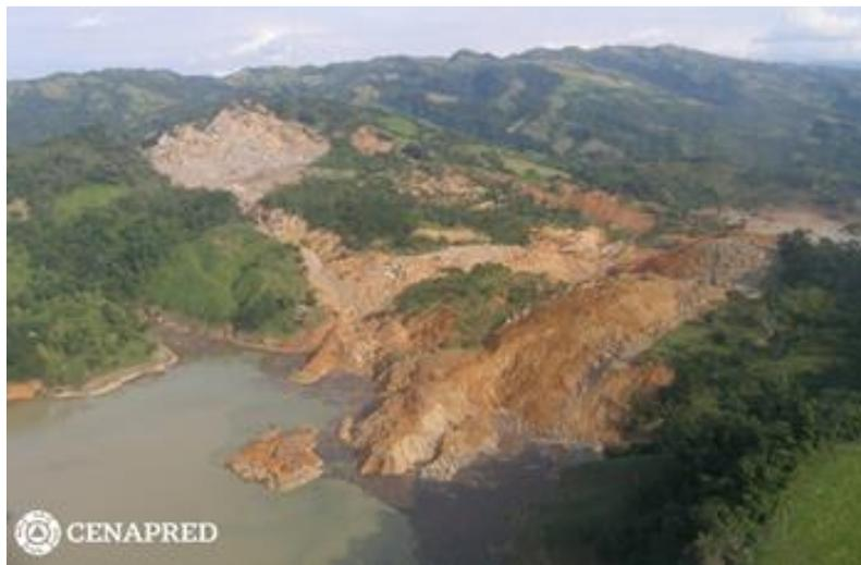
**Fig. 3** Deslizamiento y caída de roca en la margen derecha del río Grijalva, sucedido el 4 de noviembre de 2007, a la altura de la comunidad Juan de Grijalva, municipio de Ostucán, Chiapas (
