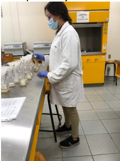
Figura 15. Filtrado de muestras para titular y tomar lectura en el Flamómetro.
