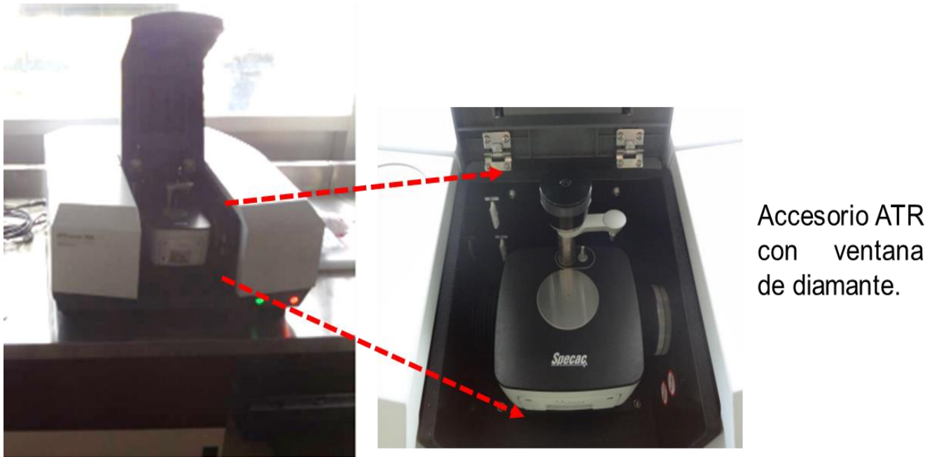
Figura 16. Análisis de espectroscopía IR. Espectrómetro IRTracer-100 Shimadzu®.
