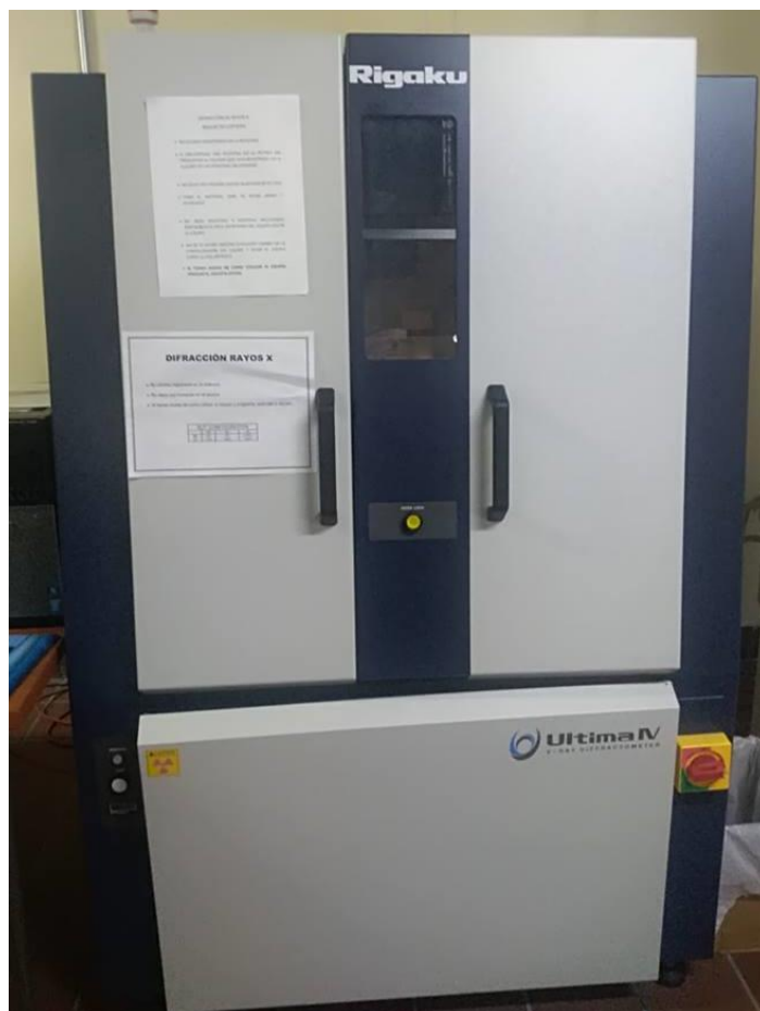
Figura 15. Análisis PXRD. Difractómetro de polvos (Ultima IV, marca Rigaku®).
