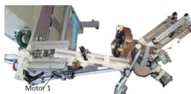
Figura 52. Se observa las vistas lateral y superior de ERMIS cuando el motor 1 está en su punto máximo con el nuevo arnés de cable.
