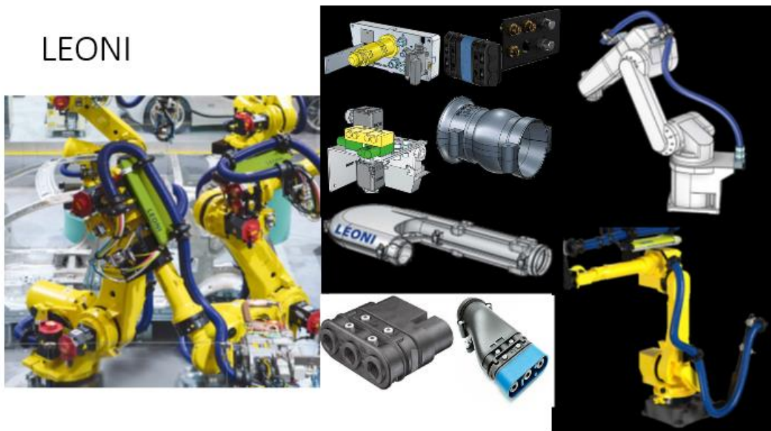
Figura 12. Formas de distribución del arnés de cable que ofrece LEONI Modificado de [45].
