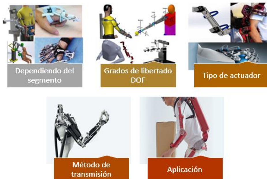
Figura 3. Muestra ejemplos de la clasificación de exoesqueletos de miembro superior.
