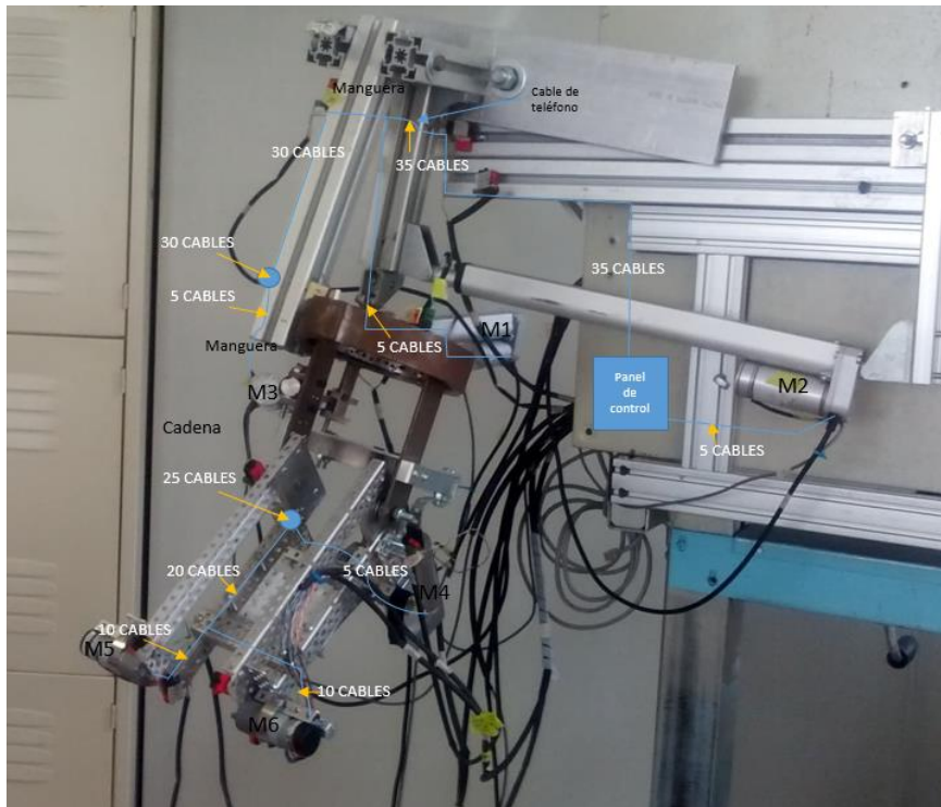
Figura 33. Vista frontal de ERMIS con el número de cables de los motores
