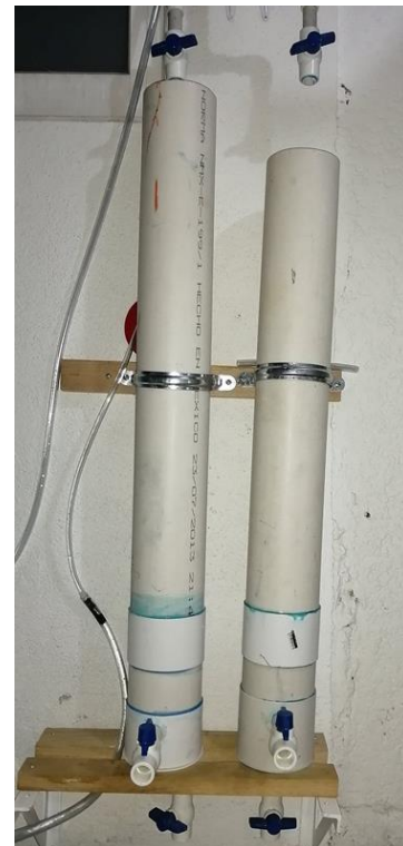
Figura 20. Contenedores, conductos de desagüe y sedimentadores FLA.
