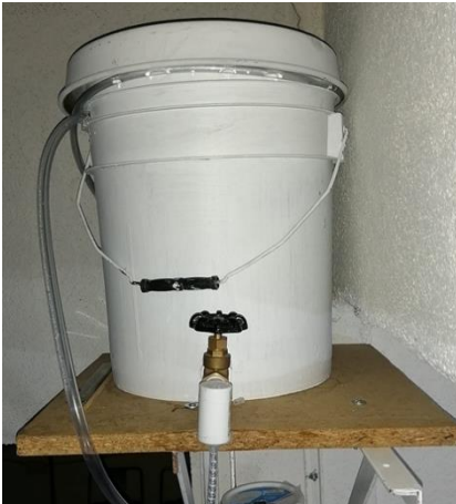
Figura 17. Contenedor y conducto de desagüe.
