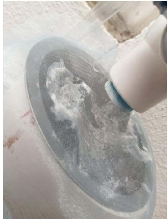
Figura 23. Retención de sólidos con rejilla metálica y tela de organza.
