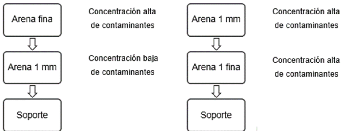
Figura 6. Concentración de contaminantes de acuerdo con el orden del lecho filtrante.
