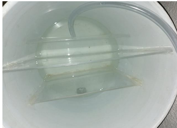
Figura 16. Paredes de separación de acrílico en el interior del contenedor.
